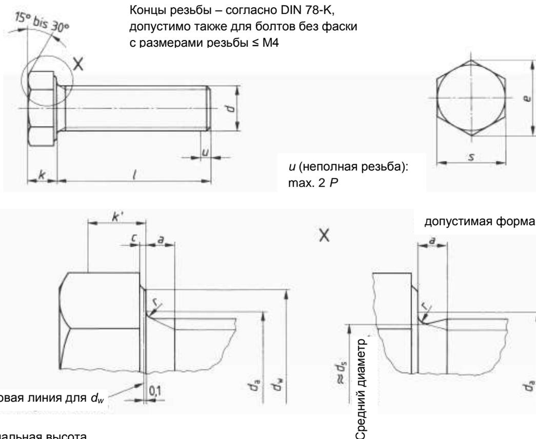
$k$  – минимальная высота для захвата ключом ( $0,7 k \text{ min.}$ )
